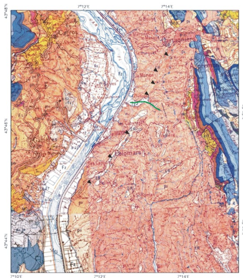
Figure 1 : Carte géologique de la moyenne vallée du Var : la trace en surface de l'anomalie morphologique du vallon de Saint Sauveur-Donaréo est indiquée par les triangle noirs. Le tracé de l'expérience de tomographie électrique est en vert et va du fond du vallon de Roguez jusqu'à la nécropole.
