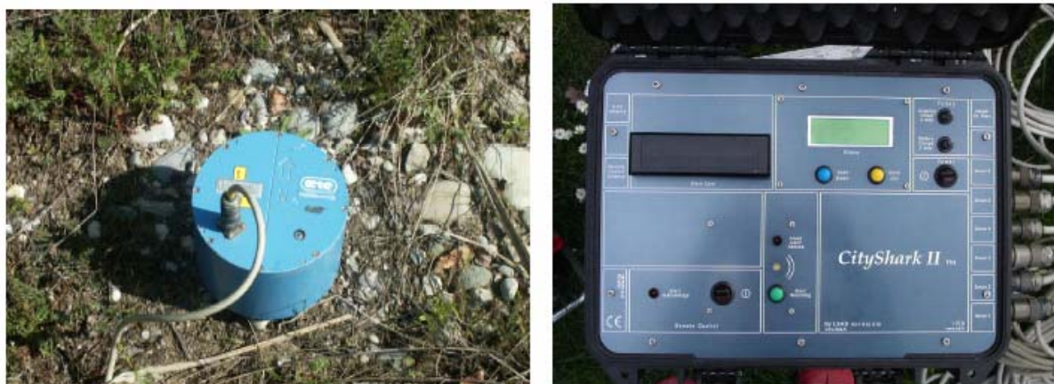
Figure 5 : Capteur et station d'enregistrement utilisés pour l'enregistrement du bruit de fond.
