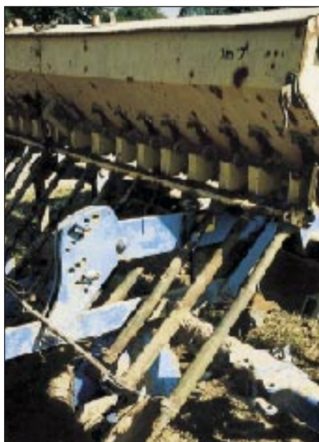
Semer une interculture sans perdre de temps : exemple d'un semoir à céréales recyclé sur un néodéchaumeur.
