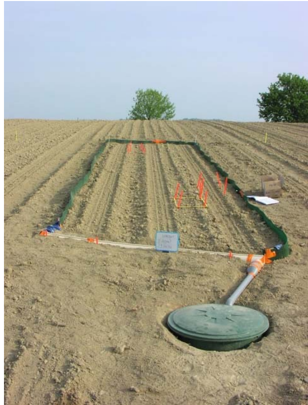
Figure 8 : Placette expérimentale (15 m 2 ) de mesure du ruissellement. Source : Armand, 2004
